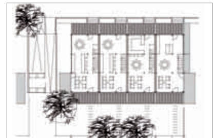
Grundriss Erdgeschoss; Flexible, veränderbare Grundrisse durch Modulbauweise
