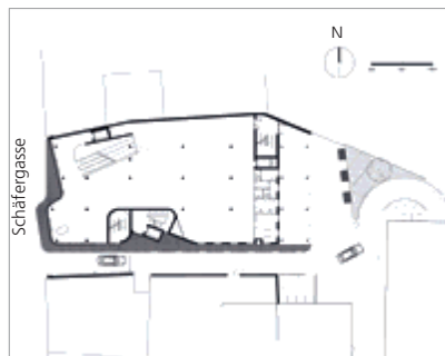
Die Flächen der Gewerbe-geschosse sind frei einteilbar und über einen Luftraum verbunden. Die Wohngeschosse ermöglichen im 2. und 4. Obergeschoss das „Durchwohnen“ von der Schäfergasse bis in den Innenhof.
